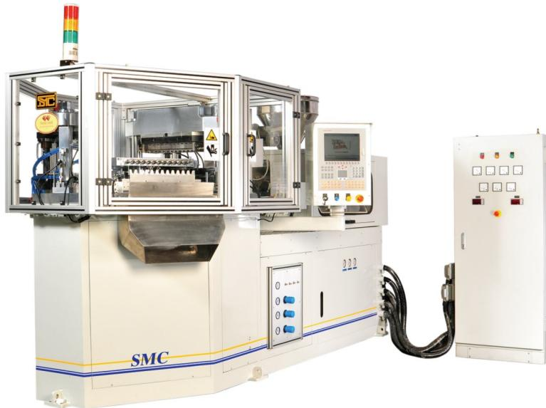
Инжекционно-выдувная машина SMC 85IB
