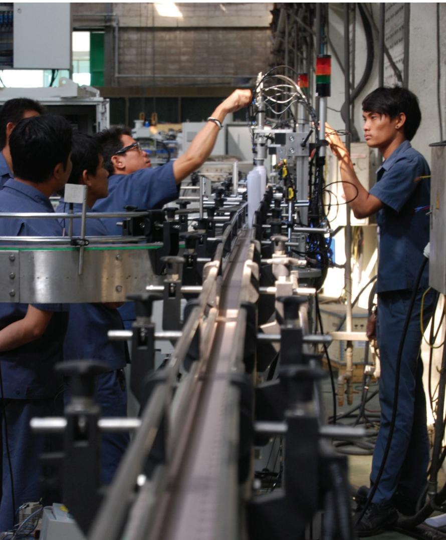
Инженеры SMC настраивают конвейеры и тестер герметичности
