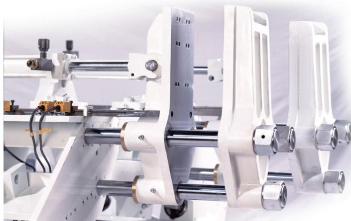
Проверенная временем концепция узла смыкания с тремя направляющими колоннами обеспечивает хорошее распределение усилия смыкания по поверхности плит. Цилиндр смыкания, раскрываясь, применяет усилие на центр задней плиты и одновременно притягивает переднюю плиту на встречу задней. Таким образом, две плиты до смыкания проходят одинаковое расстояние. Синхронность движения плит контролируется системой из центральной шестерни и двух зубчатых реек, прикреплённых к каждой из плит.
