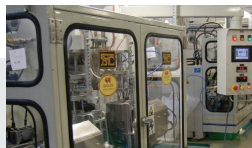
В качестве удешевления машина может быть оснащена упрощённым контроллером Omron. Эти контроллеры имеют простейший и понятный интерфейс и позволяют управлять всеми основными функциями. Данный вариант может подходить для простых маленьких машин без паризон-контроля, для несложных изделий без частых перенастроек.
